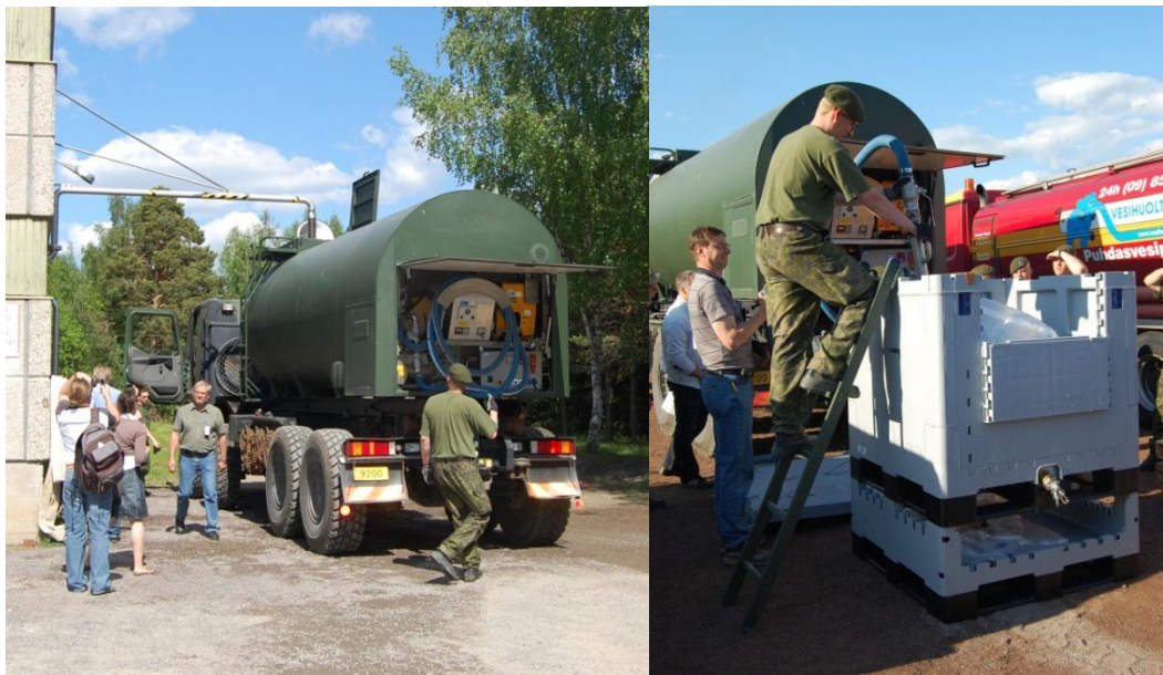
Bild 7. T.v. pumpas vattnet från vattentäkten till en tankbil, t.h. pumpas vattnet ur tankbilen i en Combo Aqua-behållare.
