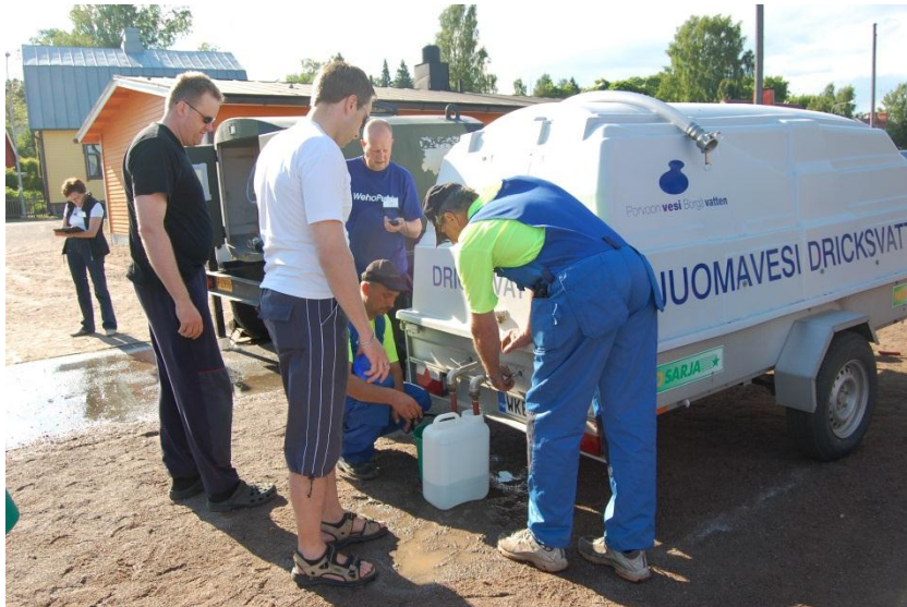
Bild 5. Fast vattenbehållare för 1 m 3 på släpvagn.
