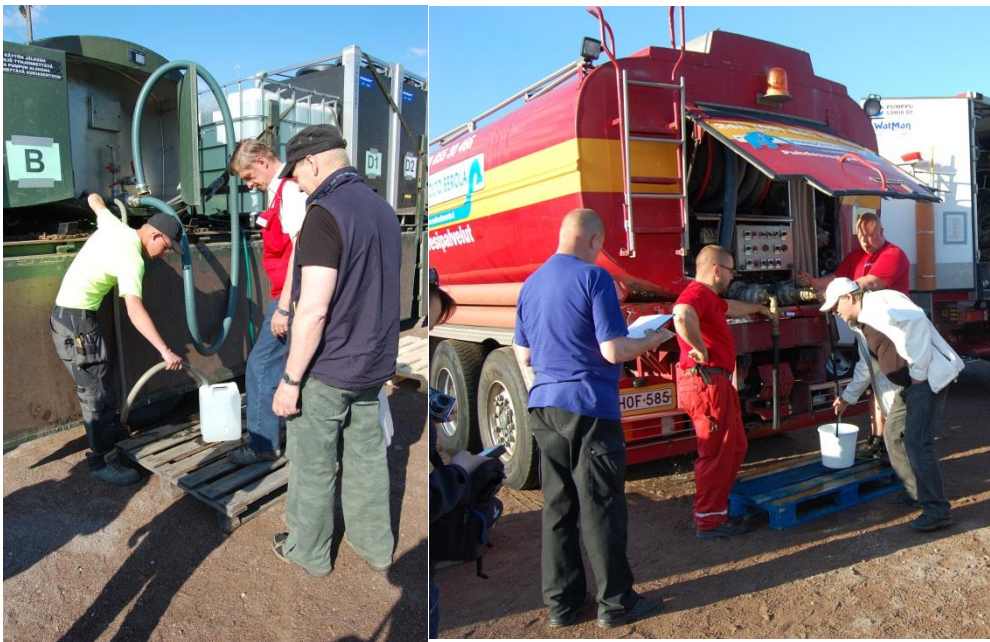
Bild 4. Försvarsmaktens vattenbehållare för 2 m 3 och Vesihuolto Eerolas tankbil för 14 m 3 med pump och värmeisolering.
