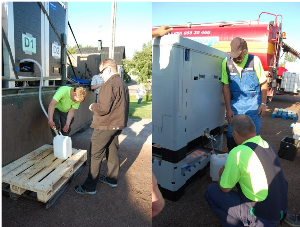
Bild 6. Hopfällbar behållare för 1 m 3 av typen Combo Aqua med en engångsvattenpåse och försvarsmaktens värmeisolerade behållare för 0,75 m 3 .
